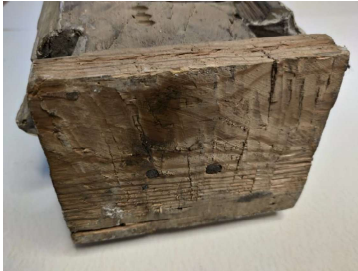
3 il. Postamentas, pritvirtintas kaltinėmis vinimis. Matomas trūkis apačioje
