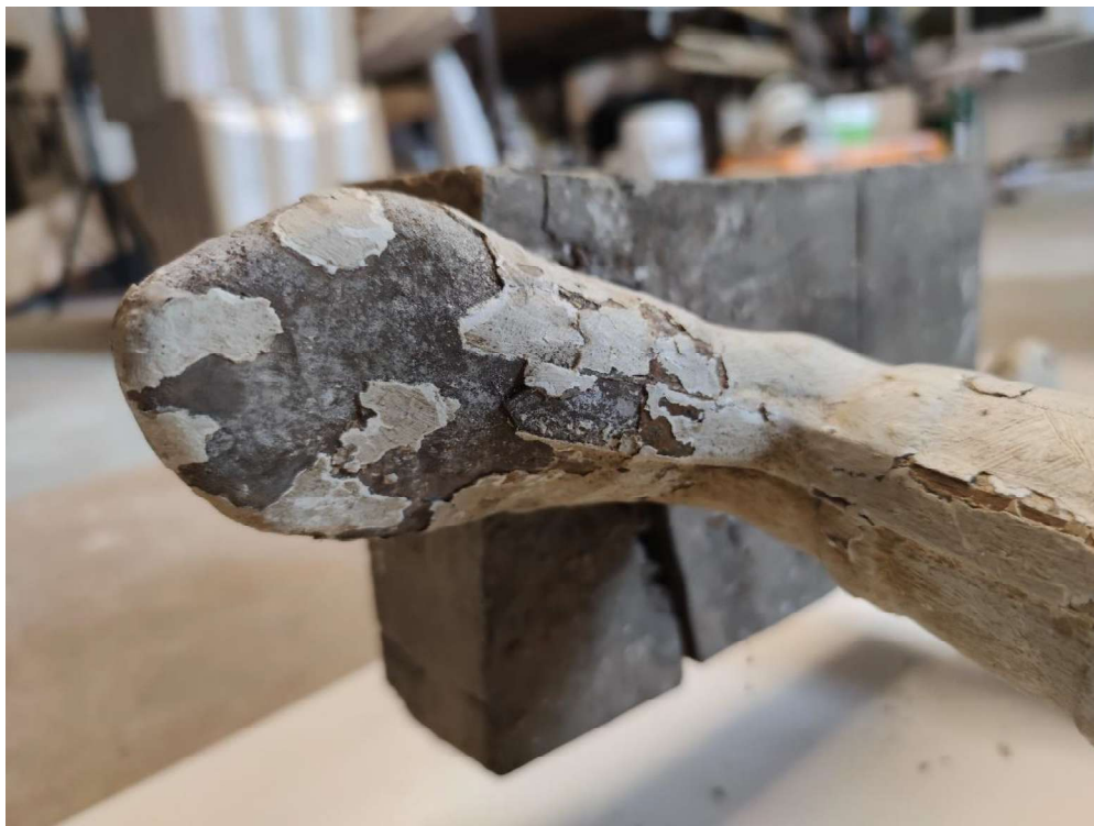
Autentiškas gruntas vietomis atsokęs nuo pagrindo, birus. Mediena patamsėjusi, pažeista mikrobiologinių pažeidėjų
