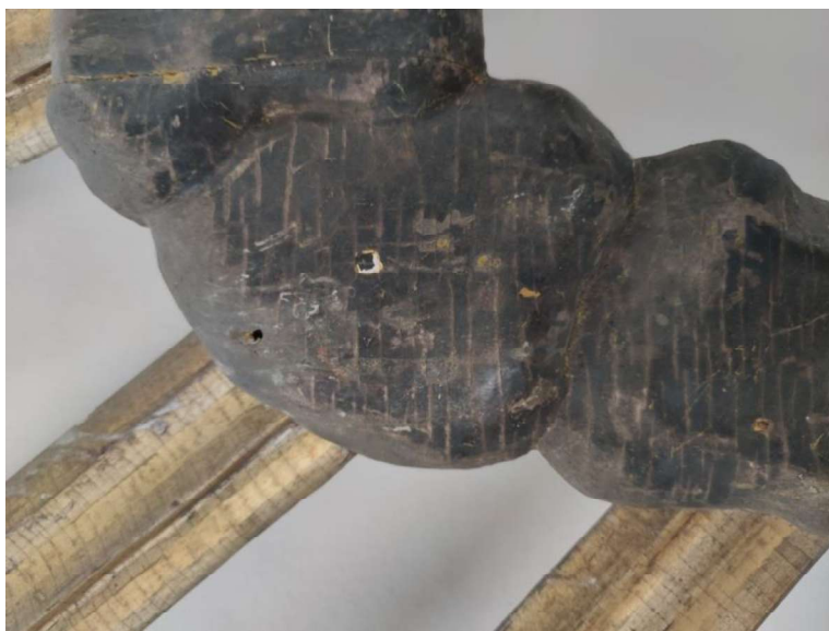
10 il. Krakeliūros debesų vainiko paviršiaus plote
