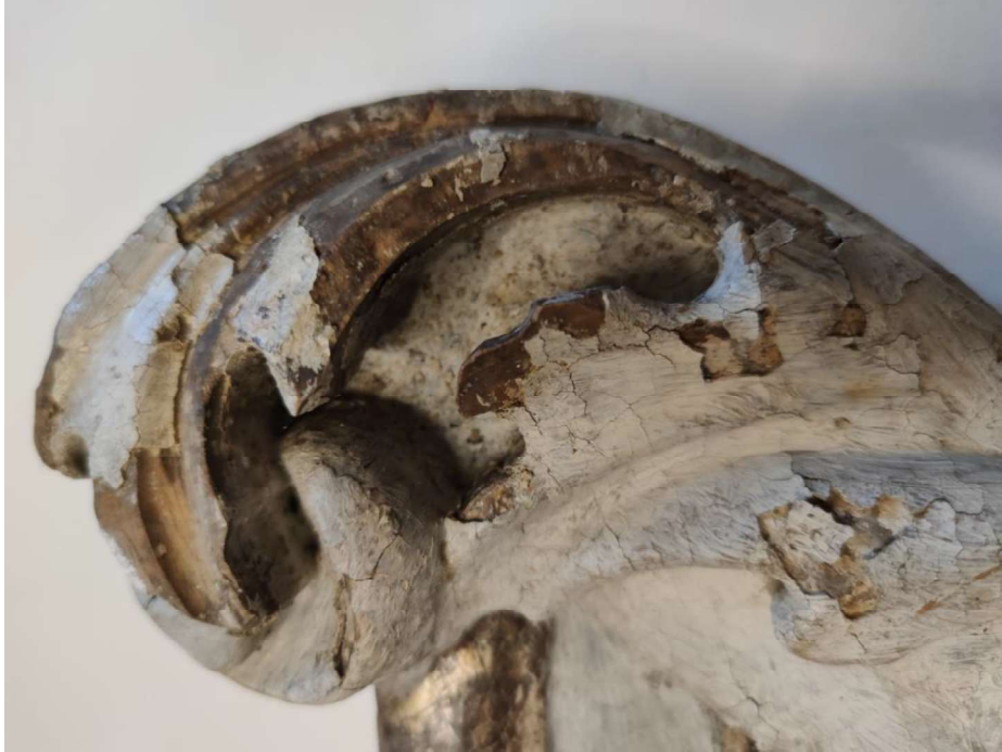
6 il. Birus, nuo pagrindo atšokęs gruntas arfos paviršiuje
